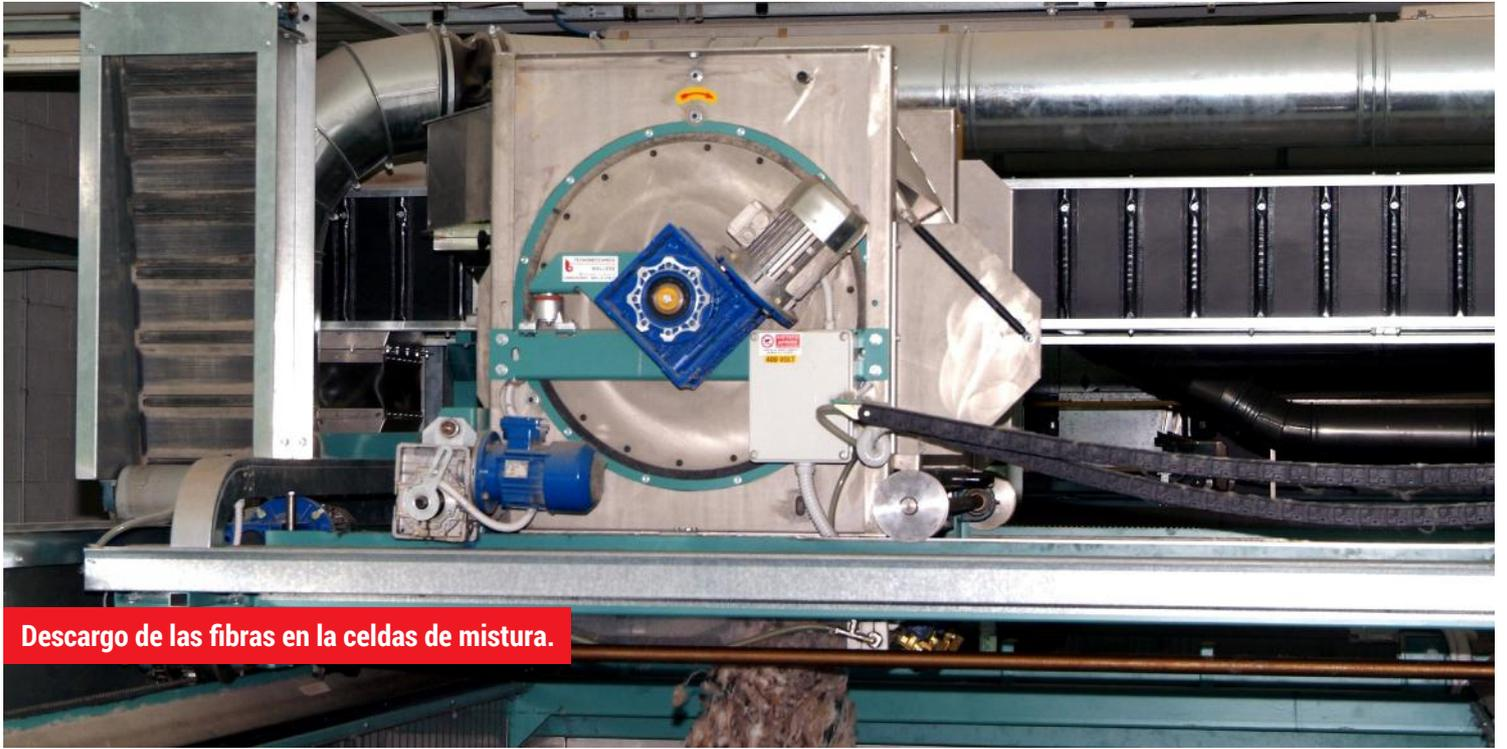
Descarga de las fibras en la celdas de mistura.
